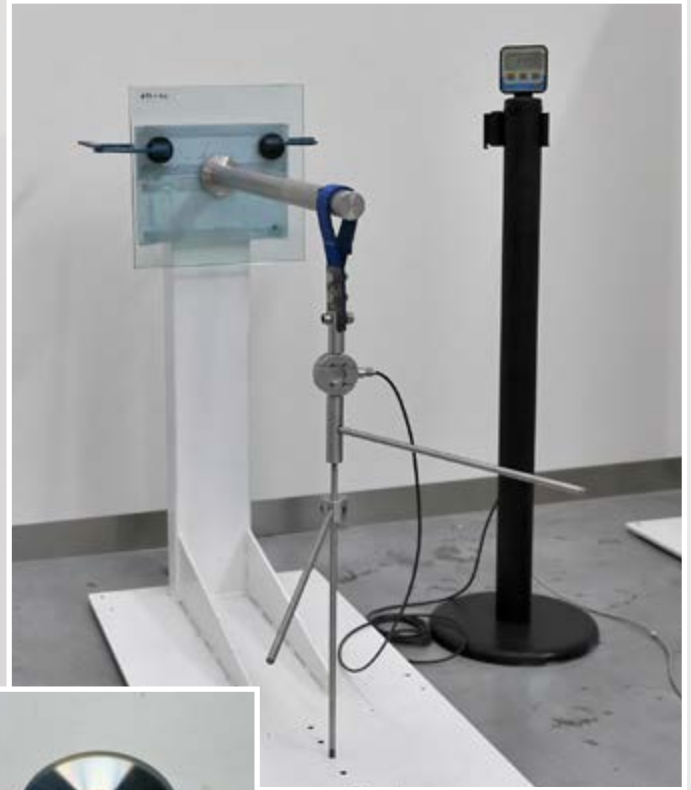
Prueba de resistencia a tracción / corte disco de acero \varnothing 75 mm
