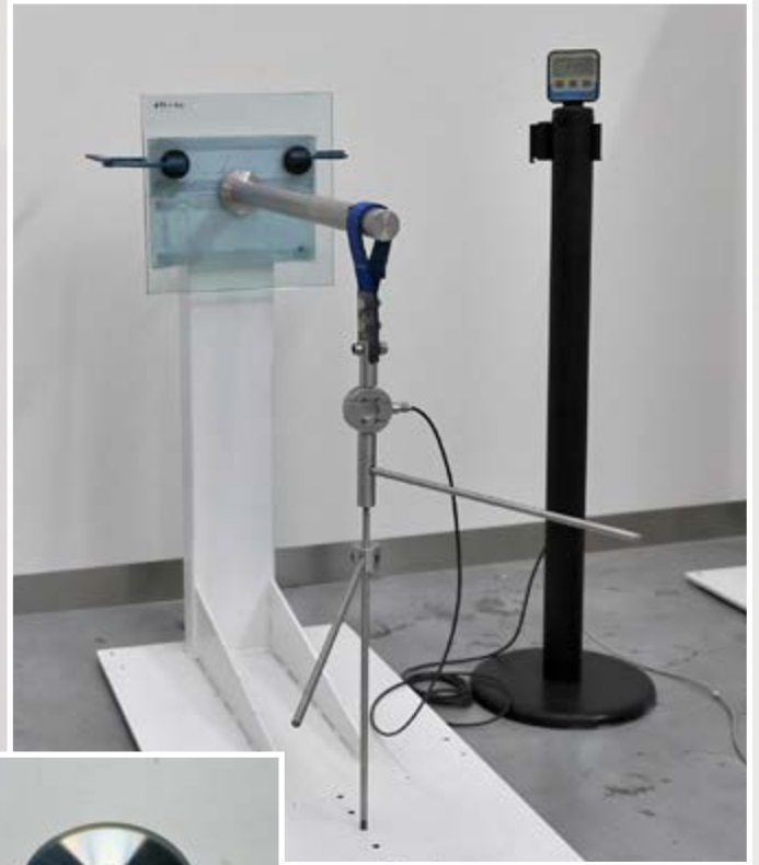
Test de résistance à la traction et à la coupe d'un disque en acier de 75 mm de diamètre
