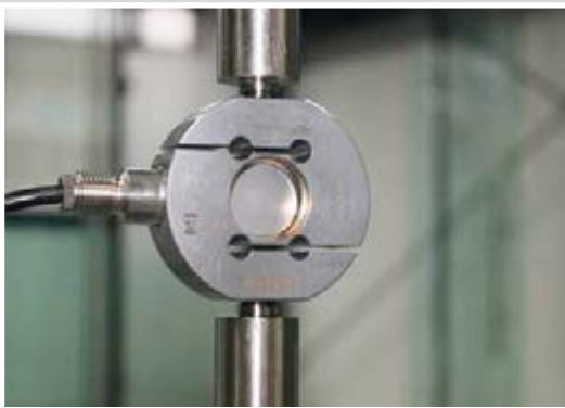
Cellule de charge (capacité 2.0 kN)
