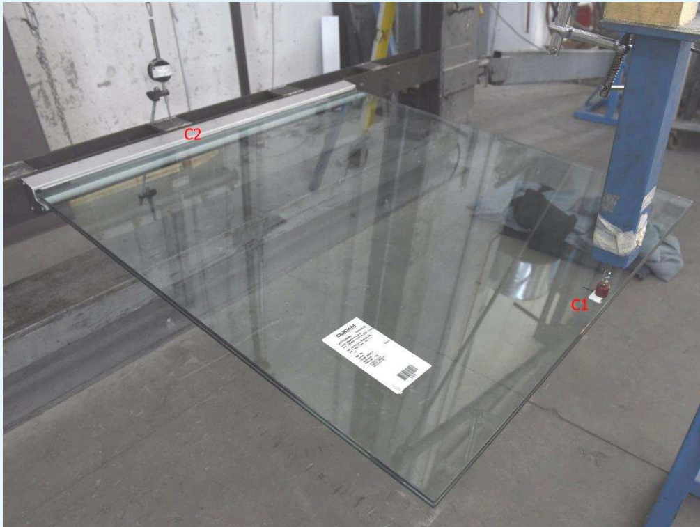
Fotografia del campione con indicata la posizione dei punti di misura.
