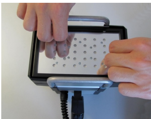
Fig. 3: Rimozione dell'unità vetro di protezione
