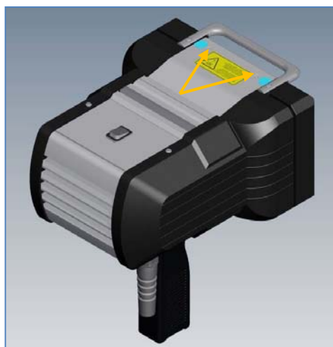
Fig. 2: Viti di fissaggio dell'unità vetro di protezione (lato superiore e inferiore dell'alloggiamento)
