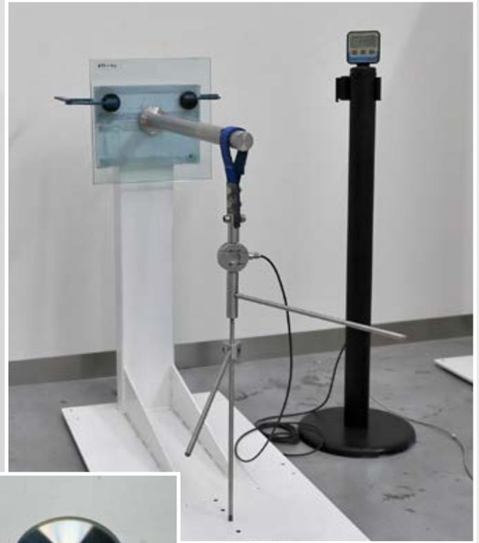
Prova di resistenza a trazione / taglio
