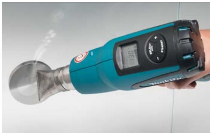
Gli adesivi UV non completamente catalizzati portati a 130°C rammoliscono, permettendo il recupero del vetro e degli accessori. Il termosoffiatore grazie alla possibilità di impostare la temperatura, permette di non stressare il vetro in modo eccessivo.
