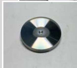
Superficie di incollaggio stressata dopo il test
