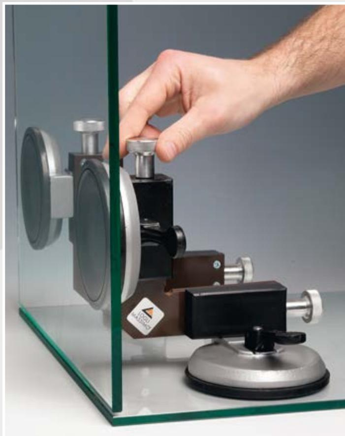
**8A)** Applicare il collante di lato lasciandolo penetrare per capillarità. Per colle a maggiore viscosità sarà necessario un tempo maggiore di penetrazione. Assicurarsi che non vi siano bolle d'aria tra le superfici da incollare.
