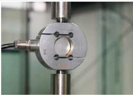
Cella di carico (capacità 2.0 kN)
