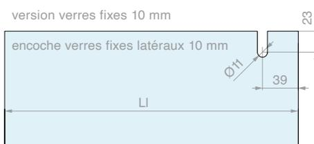
Note : les verres des vantaux mobiles et les verres fixes antérieurs ne nécessitent aucun usinage, quelle que soit la configuration.
