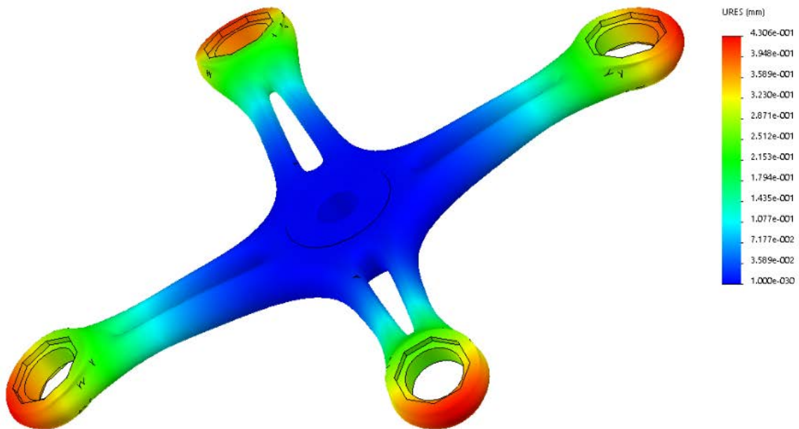
Figura 3 - schema di carico 1, vista frontale, deformata amplificata
