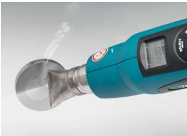
Nicht vollständig katalysierte UV-Kleber werden bei 130°C weich und erlauben so die Wiederverwendung der Glasscheibe und der Zubehörteile. Durch die Möglichkeit, die Temperatur an der Heißluftpistole einzustellen, wird die Glasscheibe nicht übermäßig stark belastet.
