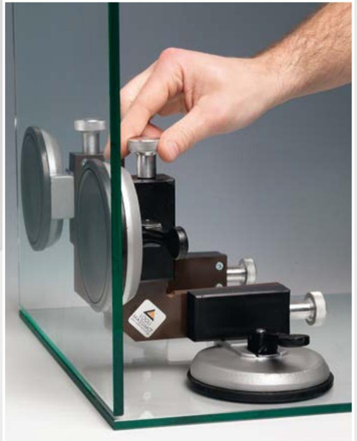
**8A)** Den Kleber an der Seite aufragen und abwarten, bis er sich durch Kapillarwirkung verteilt hat. Kleber mit höherer Viskosität benötigen eine längere Zeit für das Verteilen. Sicherstellen, dass sich keine Luftblasen zwischen den Klebeflächen befinden.
