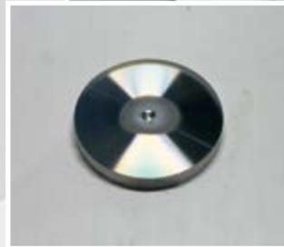
Belastete Oberfläche nach der Prüfung
