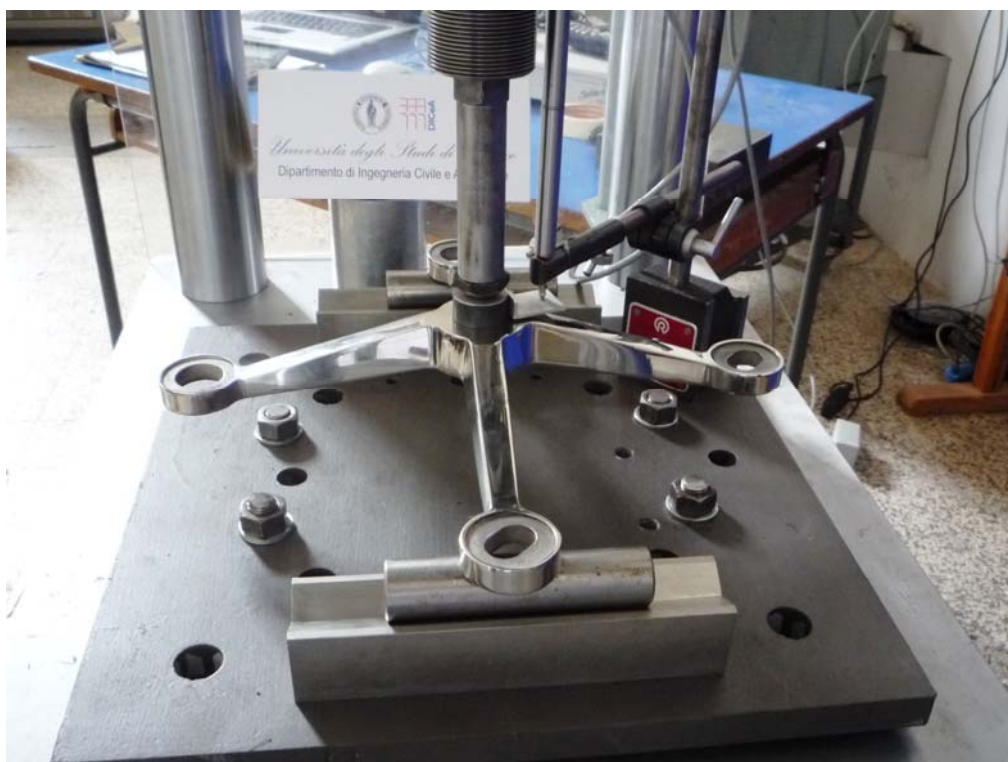
Figura 9: Prova in direzione ortogonale su Spider SP2201
