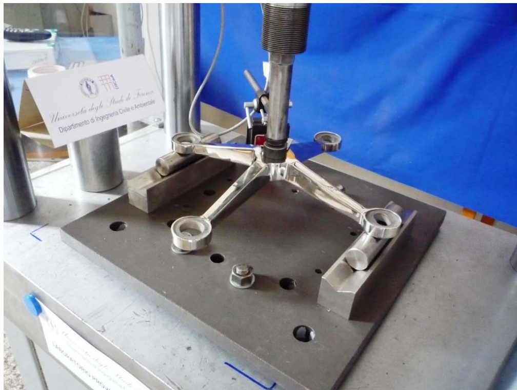
Figura 8: Prova in direzione ortogonale su Spider SP2201
