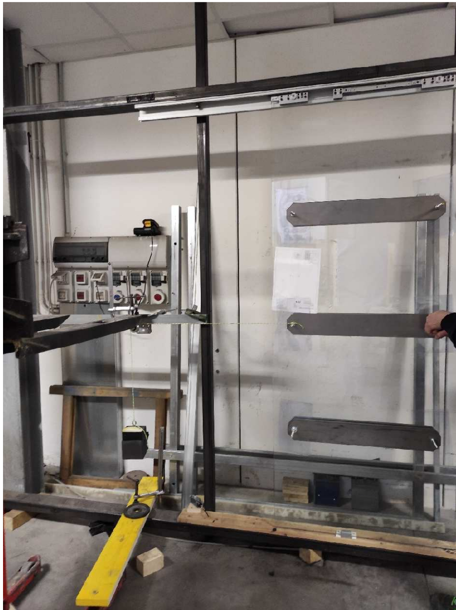
Fotografia del sistema zavorrato fino a massa totale di 100 kg sottoposto a chiusura violenta
