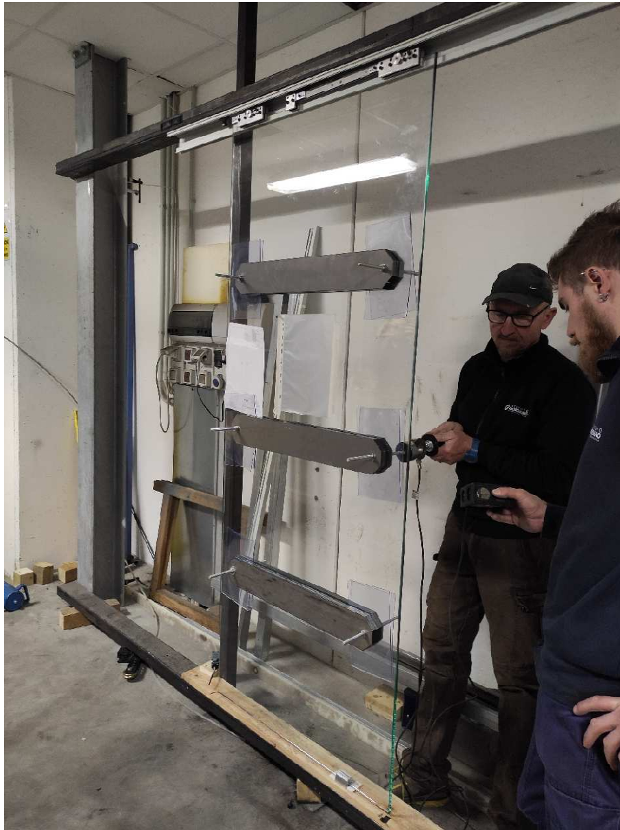
Fotografia del sistema zavorrato fino a massa totale di 100 kg sottoposto a carico statico orizzontale
