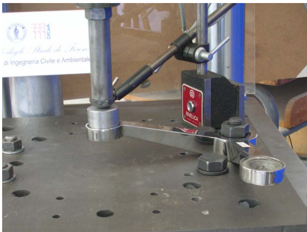
Figura 9: Prova in direzione ortogonale su Spider SP2203
