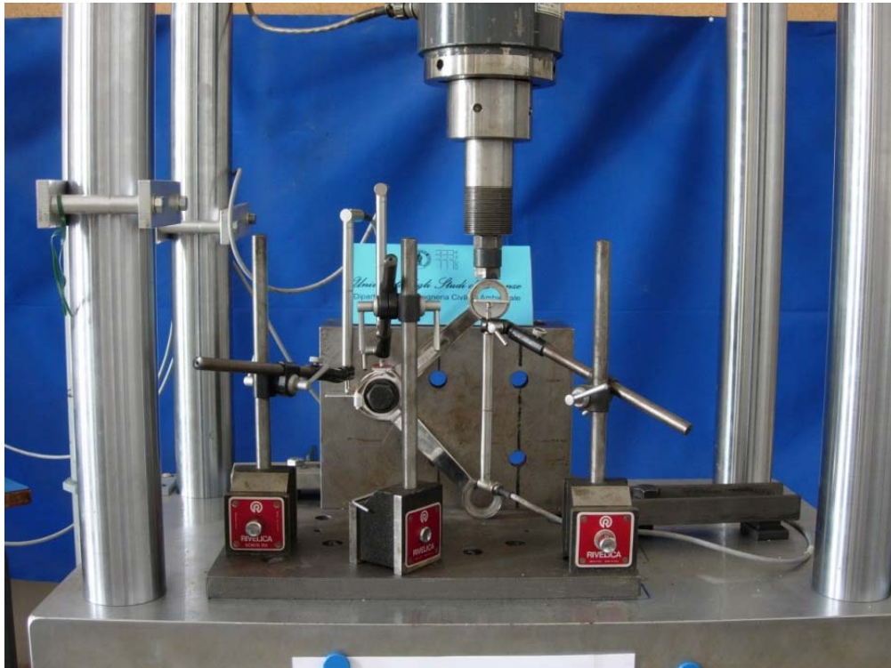
Figura 15: Prova in direzione parallela su Spider SP2203.
