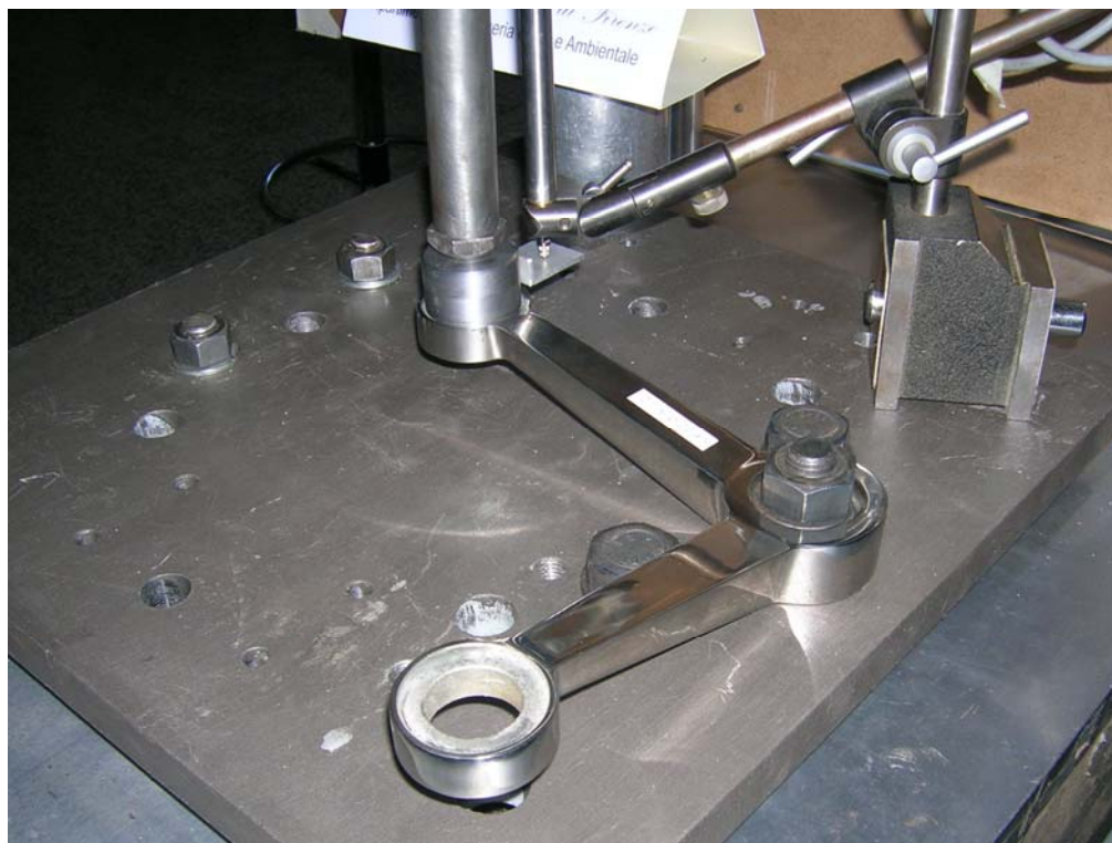
Figura 8: Prova in direzione ortogonale su Spider SP2203
