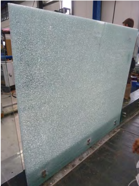
Probekörper 10 nach Versuchsdurchführung
