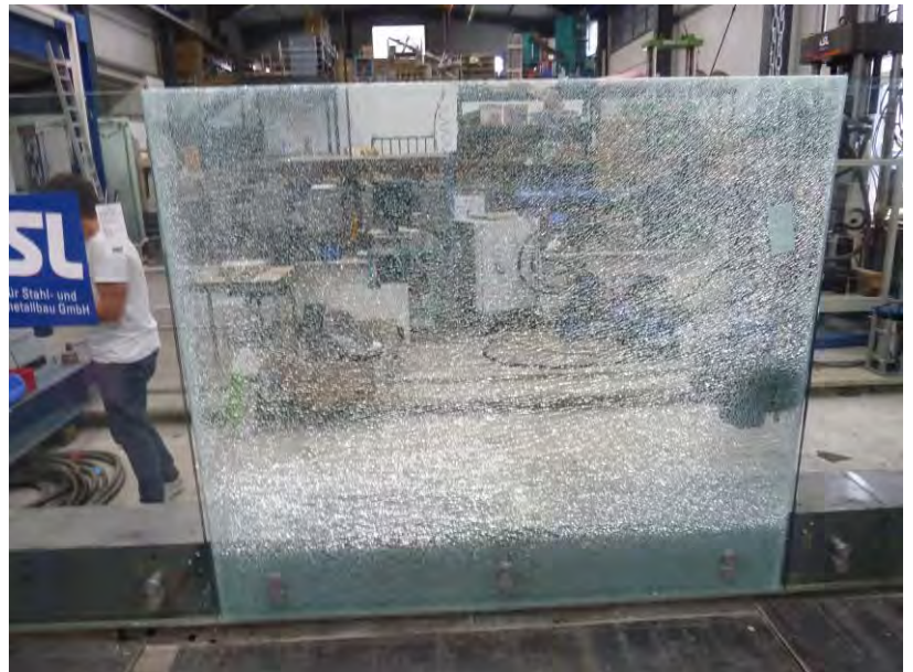
Probekörper 10 nach Schädigung der innenliegenden Einzelscheibe
