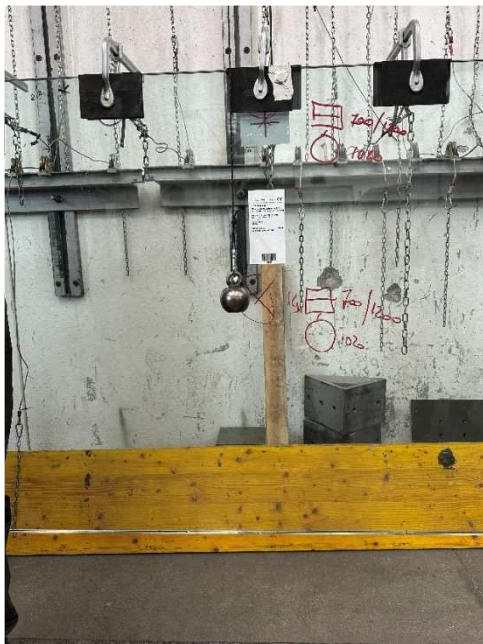
Fotografia dell'oggetto dopo l'impatto da corpo duro al centro del tamponamento
