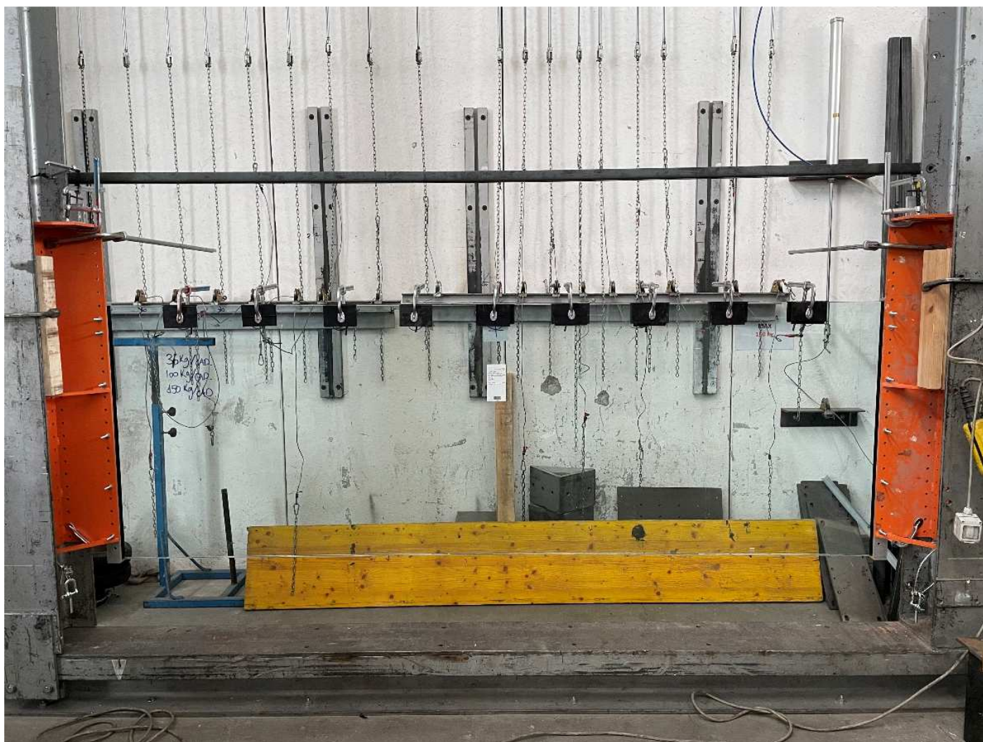
Fotografia dell'oggetto, vincolato al banco di prova tramite una coppia di guanciali in acciaio che sorreggono i due profili in alluminio laterali
