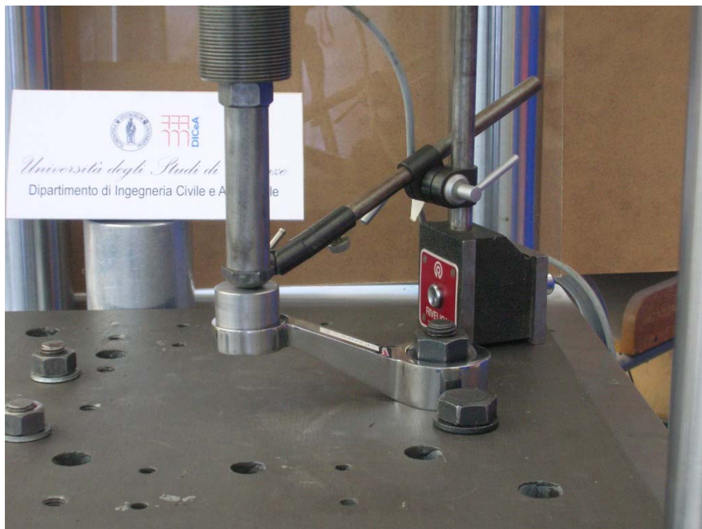
Figura 8: Prova in direzione ortogonale su Spider SP2204
