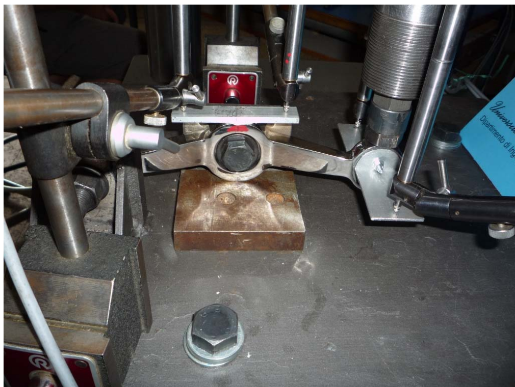
Figura 15: Prova in direzione parallela su Spider SP2202.
