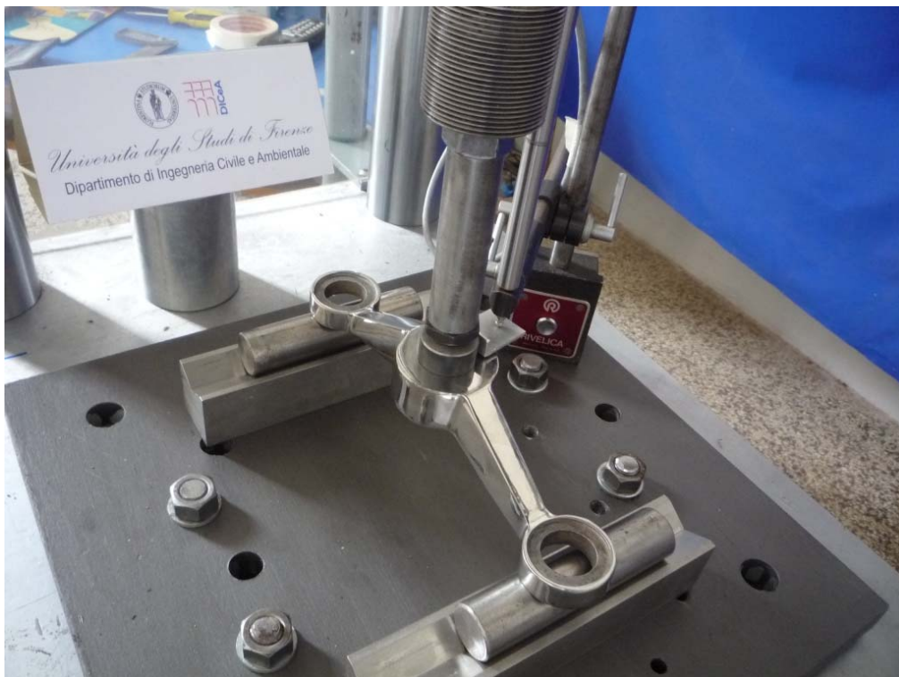
Figura 9: Prova in direzione ortogonale su Spider SP2202.
