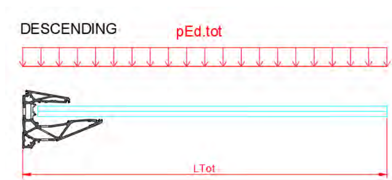
Fig: Direzione carico verso il basso
