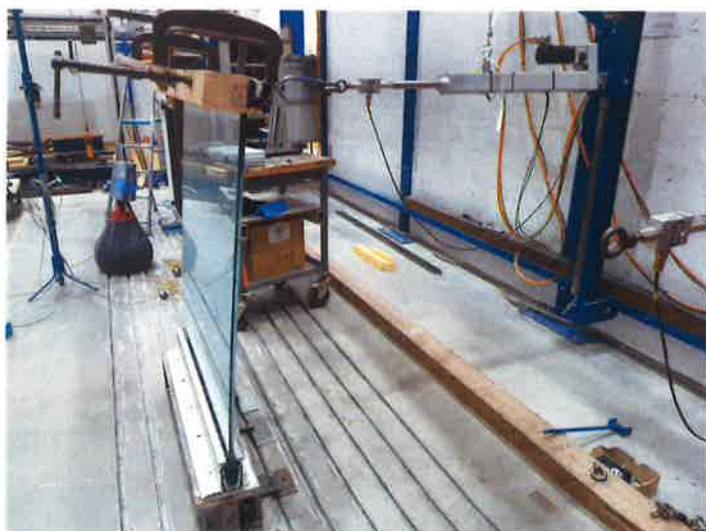
Essai statique horizontal de l'intérieur vers l'extérieur
