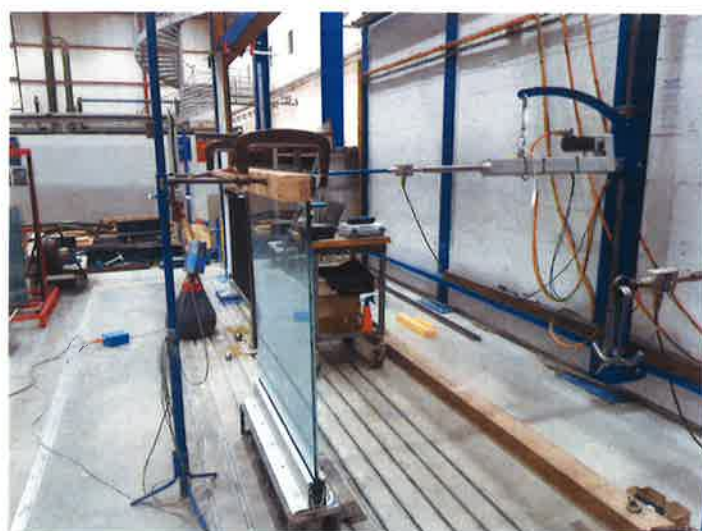
Essai statique horizontal de l'extérieur vers l'intérieur
