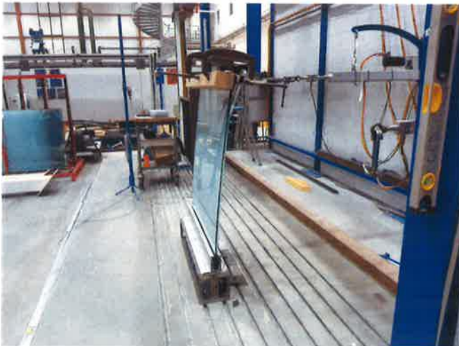
Essai statique horizontal de l'intérieur vers l'extérieur
