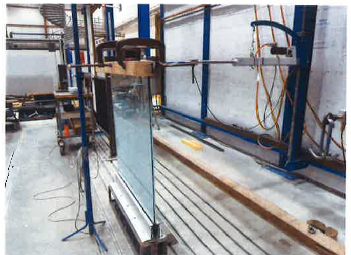
Essai statique horizontal de l'extérieur vers l'intérieur
