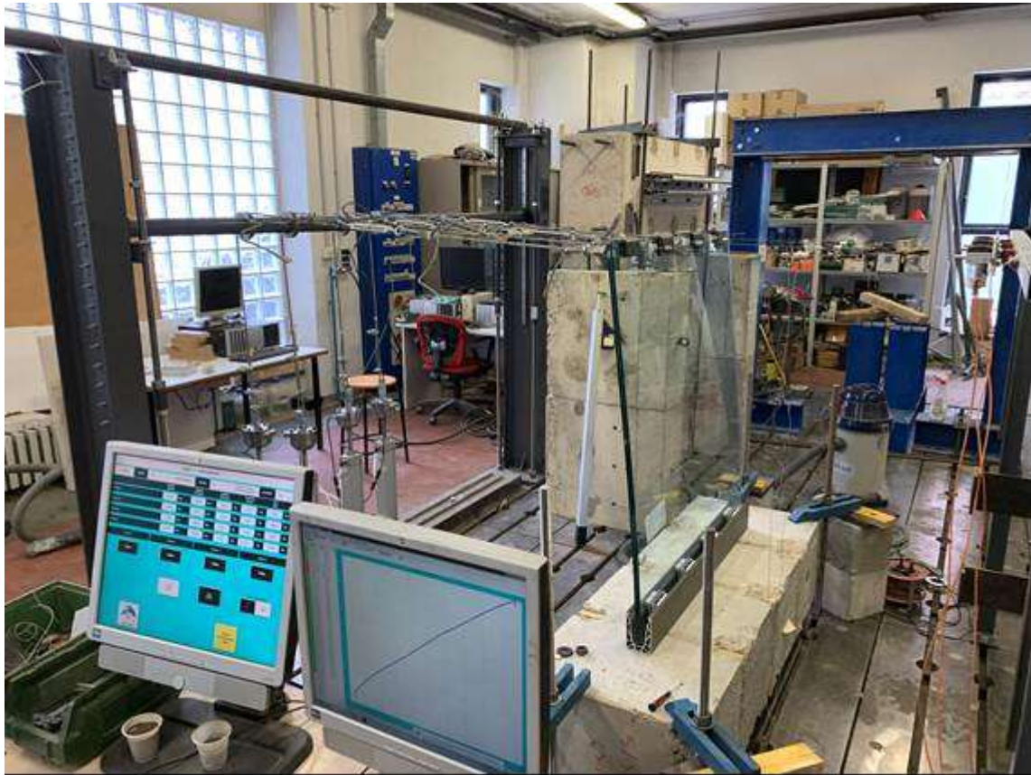
Figura 5.2 – Lastra soggetta a carico
