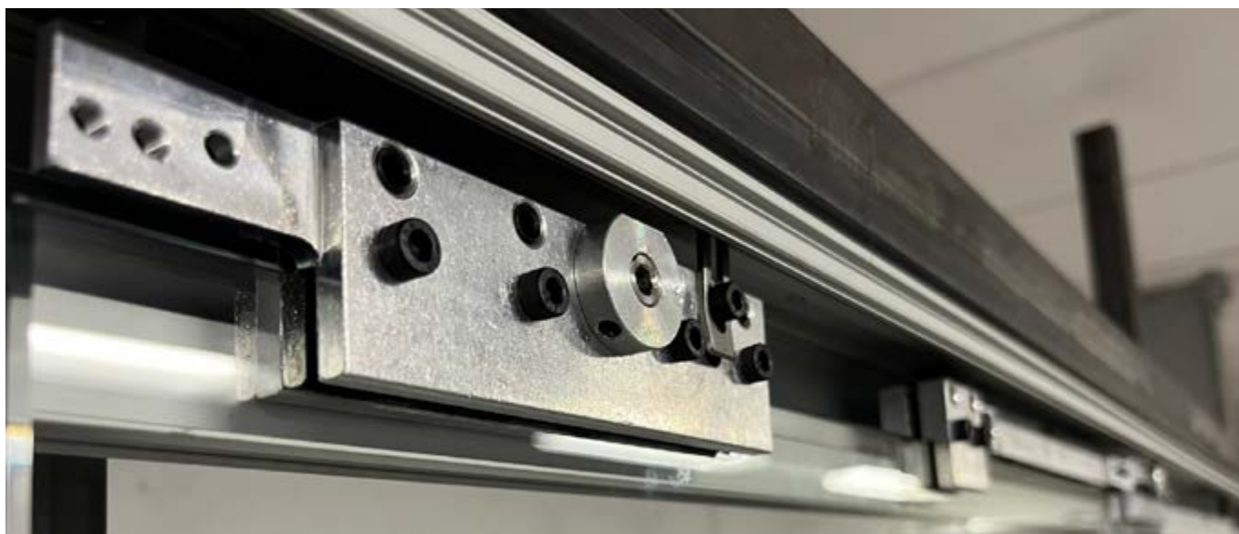
Pinza interamente in alluminio
